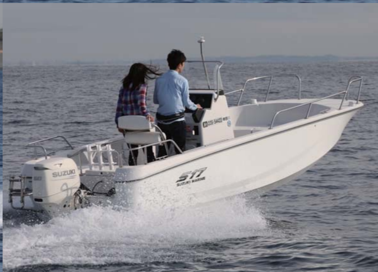
ワイドなトリマランハルを採用し、安定感抜群の走行性能を実現している。船外機はDF30A~DF60Aで選択でき、60psではより爽快な加速を楽しめた。
