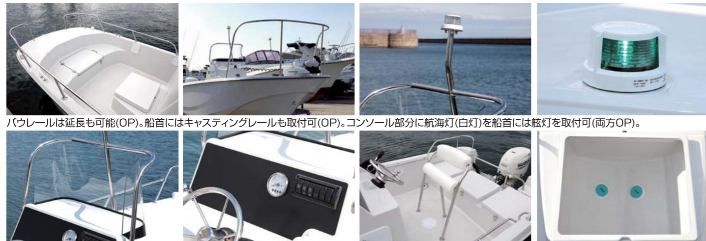
グラブレールマスト付きのウインドシールド(OP)。メーターパネル(OP)の質感も良い。リーニングシート(OP)で操船も快適。イクススキャッパー(OP)も取付可。
