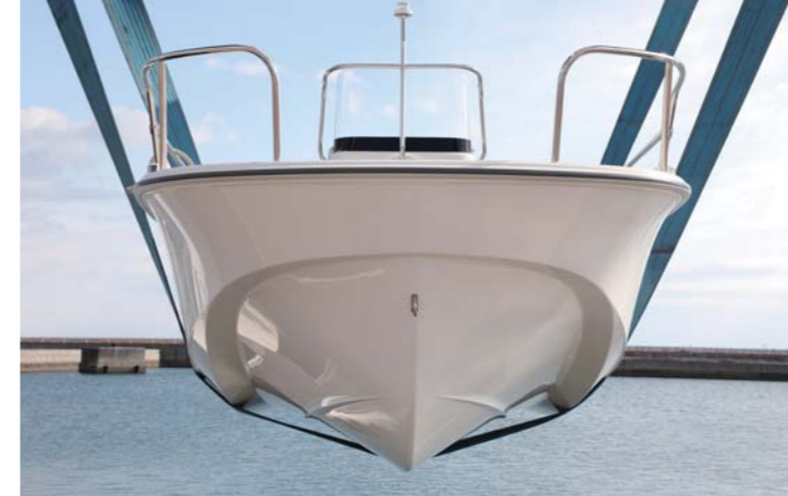
ワイドなトリマランハルを採用し、安定感抜群の走行性能を実現している。船外機はDF30A~DF60Aで選択でき、60psではより爽快な加速を楽しめた。
