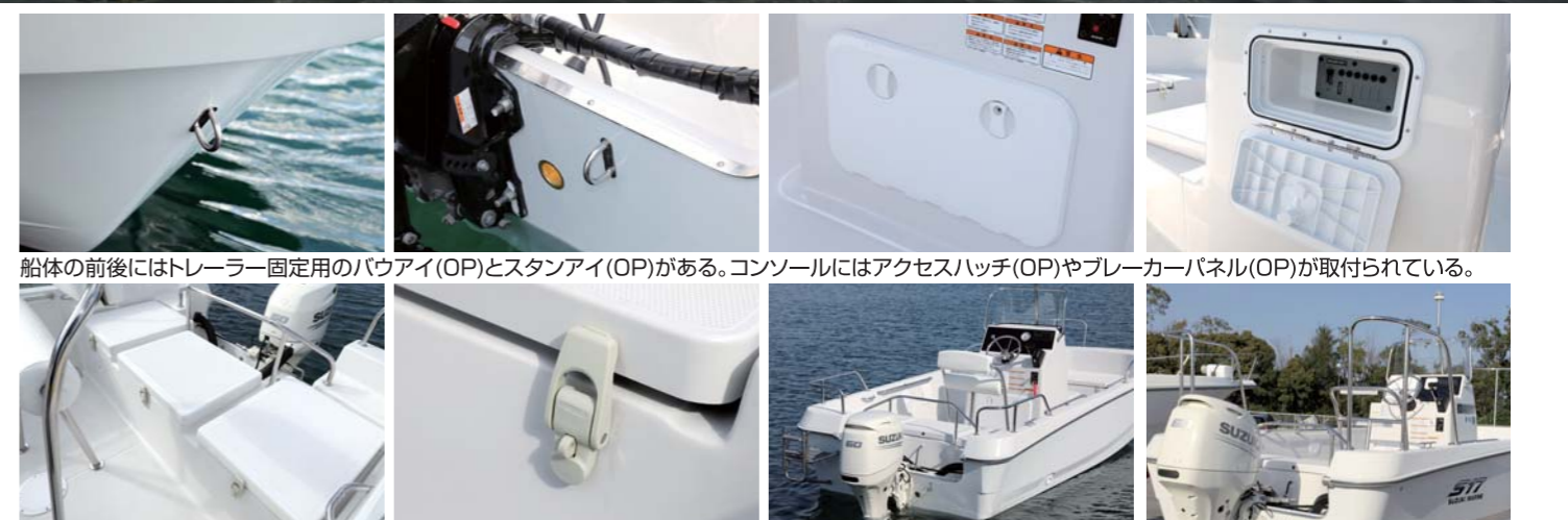
スタンデッキの収納にはスタンハッチロック(OP)が付いている。スタンレール(OP)を取付けることで安全性も向上する。キャストングレールのオプションもある。
