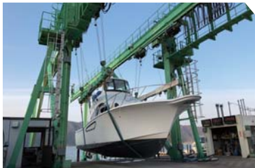
最大吊能力12トン 大型クレーン
