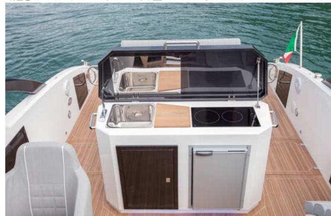
デッキ中央には、ソファの背もたれを兼ねた大型のキャビネット。前面にフロントローディングのリフレジレーター。上部を開けると、シンクと電気コンロ、カッティングボードが現れる。
