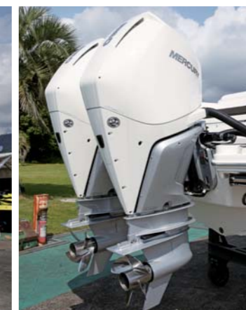
シーレイ特有の流線型のフォルムにマーキュリーの新型船外機を2機搭載。エンジンは水中排気と空中排気の切替が可能。
