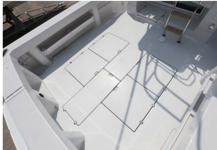
フラットなアフトデッキは最大幅2715mm、奥行き2900mmと抜群の広さ。
