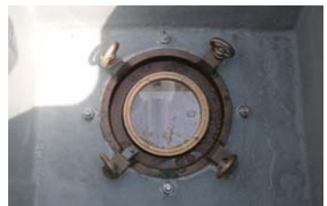
アフトデッキにはプロペラ点検窓がある。エンジンは前方部分はキャビンから、後方部分はアフトデッキからチェックが可能。ステップも広く、乗り降りもスムーズ。
