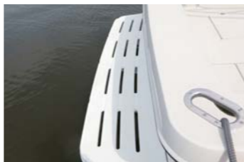
アフトデッキにはプロペラ点検窓がある。エンジンは前方部分はキャビンから、後方部分はアフトデッキからチェックが可能。ステップも広く、乗り降りもスムーズ。
