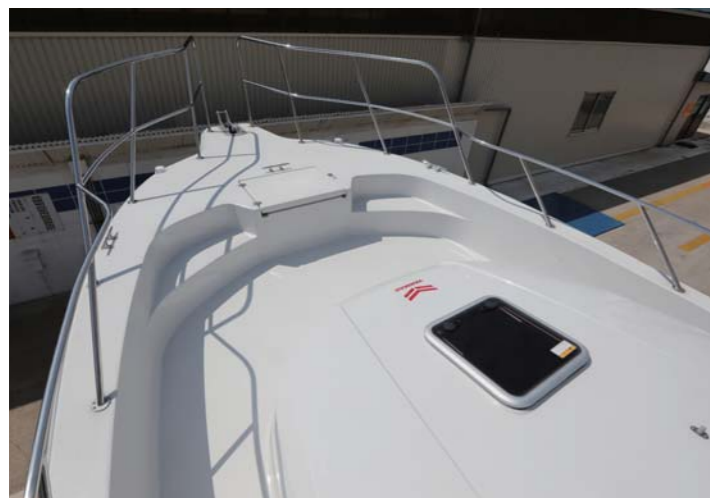
新形状のフレアー船型により、バウには広い釣りスペースが確保されている。
