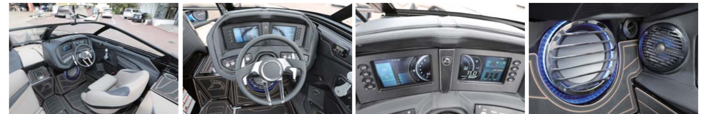
ヘルムでは両サイドにシステムディスプレイを搭載。タッチパネルになっており、様々な機能を使用することができる。足元にはウーファーとスピーカーを配置。
