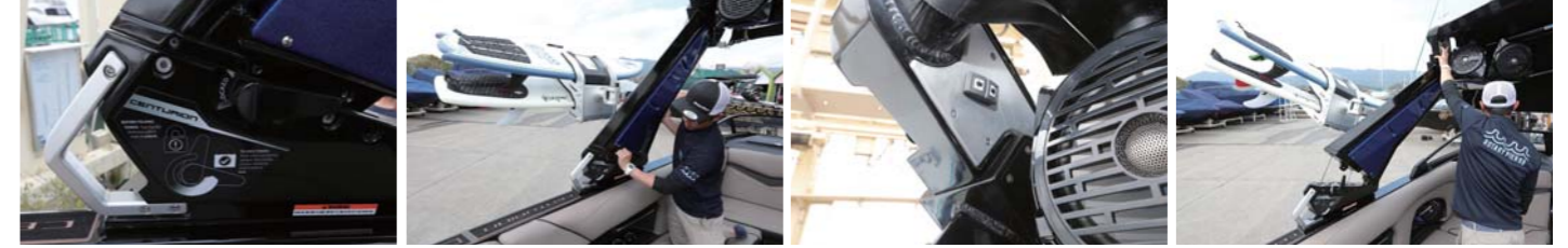
ウェイクタワーは電動操作が可能だ。倒す際はまずタワーの根元にあるロックを解除し、スピーカー付近にあるスイッチを操作することでゆっくりと倒せる。
