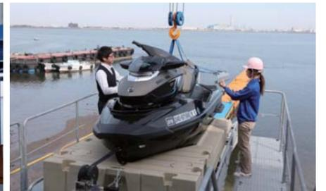
クレーンを新設したことで、これまで以上にスピーディかつ安全に揚降してくれる。水上バイクを吊り上げた後は、フロートに乗せてスロープで降ろしていく。
