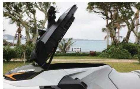
フロントストレージはドリンクや用具箱をシートに座りながら取り出せる。完全防水型のスマートフォンボックスは別売りのUSBポートを付ければ充電も可能だ。
