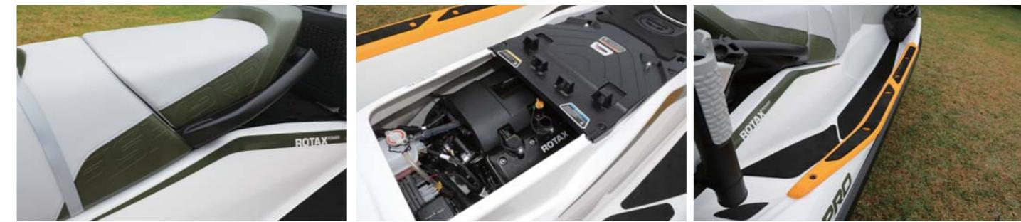
長いベンチシートでは2人横並びで釣りができる。エンジンはRotax 1503 NAを搭載。フットレストは傾斜付きなので、横向きに座っても体を固定しやすい。
