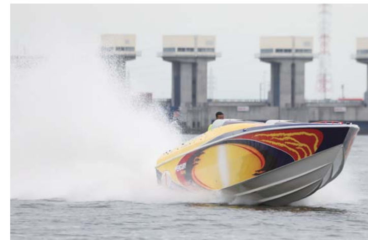
シガレット42レボリューションはスーパーチャージャーの追加装備やエンジンをリビルドしたことで、525HP→750HPにグレードアップされている。
