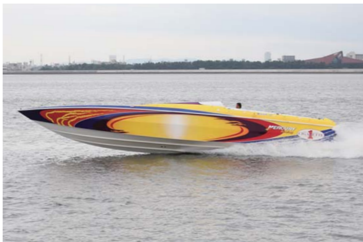
シガレット42レボリューションはスーパーチャージャーの追加装備やエンジンをリビルドしたことで、525HP→750HPにグレードアップされている。
