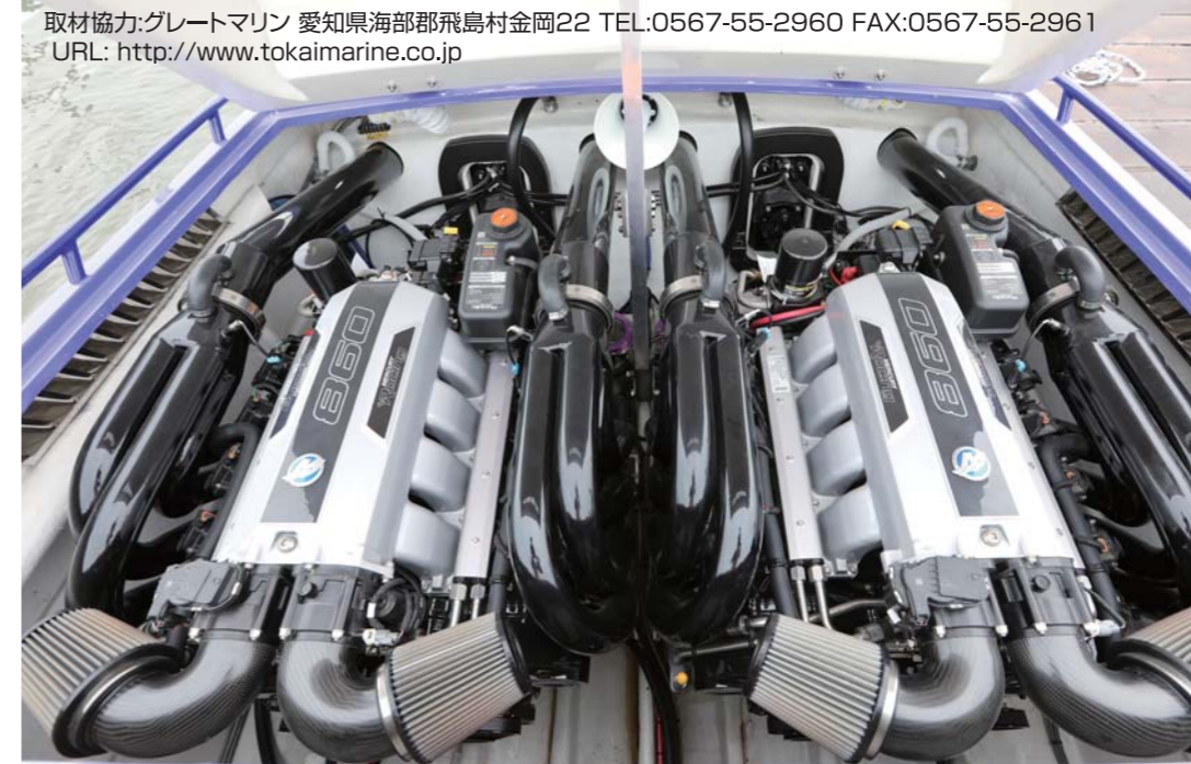
エンジンはマークルザーレーシング860HP(新品)を2基搭載。間接冷却のため、塩害の心配も無い。
