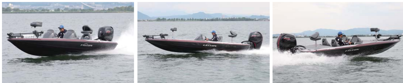
ファルコンボートは船体の幅が広く、ハル形状も水中抵抗が少ない形状になっているため、加速もスムーズで走行時の安定性は抜群に高い。
