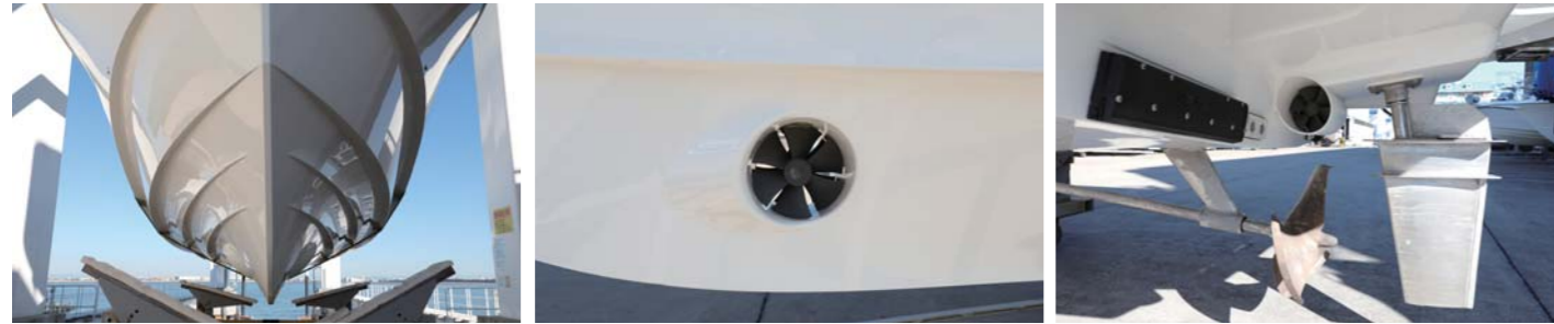
船底は鋭角のV型ハルを採用。フィンキールも大きく、凌波性と風流れ抑制性能は非常に高い。前後にはスラスタ(OP)があり、離着岸も容易だ。
