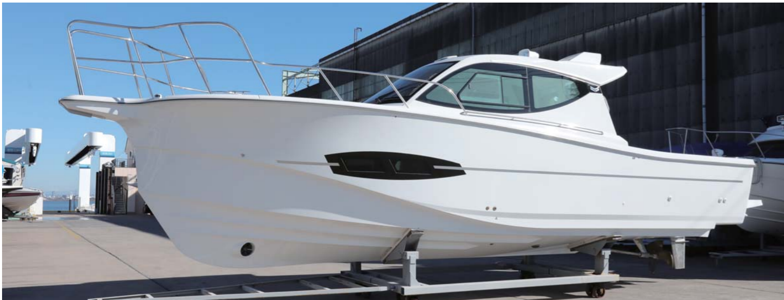
ポリウム感のあるステムデザインにより、35フィート並の水線長を持ち、高い保針性や安定性を発揮。フィートサイズ以上の快適な乗り心地を体感できた。
