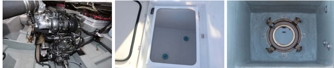
電子制御コモンレールエンジン「6LY440J」を搭載し、燃費性能も抜群だ。アフトデッキには左右に大型イケスを装備、プロペラ点検窓も確保されている。
