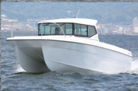
「揺れにくく、叩きにくく、流されにくい」カタマランフィッシングボート。それが今回ご紹介する「NEW JAPAN MARINE NSC265」の特徴だ。カタマランハルの持つ特性を最大限まで発揮した構造により、柔らかい乗り心地とフィートサイズ以上の安定性を実現している。このボートはより高い走行性能を求めて、従来型に対して水線長(水切り面の長さ)を約2フィート伸ばしており、横安定性を20%、推進効率を5%UPしている。これにより海上での横流れについても、これまで以上に強く
