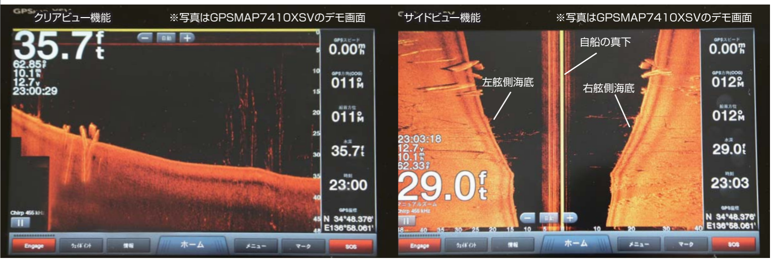
クリアビュー機能は海底の様子をかなり明確に把握できる。ワイズギアのテストによれば、水深70mの海底にある魚礁も確認できたそうだ。
