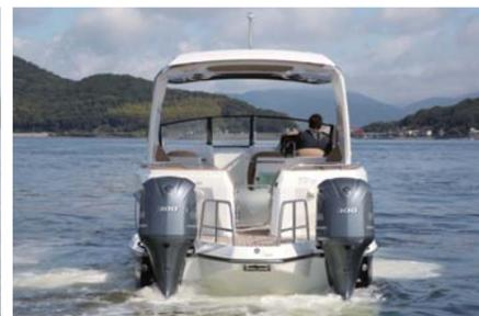
YAMAHA SR330は300馬力の船外機を2基搭載し、40ノットオーバーの圧倒的な走行性能を楽しめる。オープンボートならではの爽快感が味わえ、洗練された外観デザインは海上でも高い注目を集めそうだ。コーナー時には抜群の旋回性を発揮し、イメージ通りに旋回してくれた。素直な乗り味で、操作性は非常に高い。
