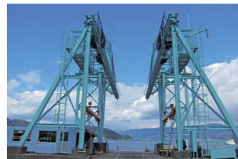
マリーナ内には大型の60フィートガントリークレーンが完備されており、小型艇~大型艇までオーナーの大切なボートを安心・安全に揚降してくれる。 取材協力:ファーストハーバーツルガ 福井県敦賀市名子37-19-1 TEL:0770-22-8777 URL:http://f-h-tsuruga.main.jp/
