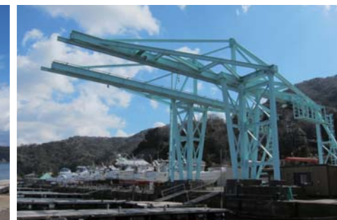
マリーナ内には大型の60フィートガントリークレーンが完備されており、小型艇~大型艇までオーナーの大切なボートを安心・安全に揚降してくれる。 取材協力:ファーストハーバーツルガ 福井県敦賀市名子37-19-1 TEL:0770-22-8777 URL:http://f-h-tsuruga.main.jp/
