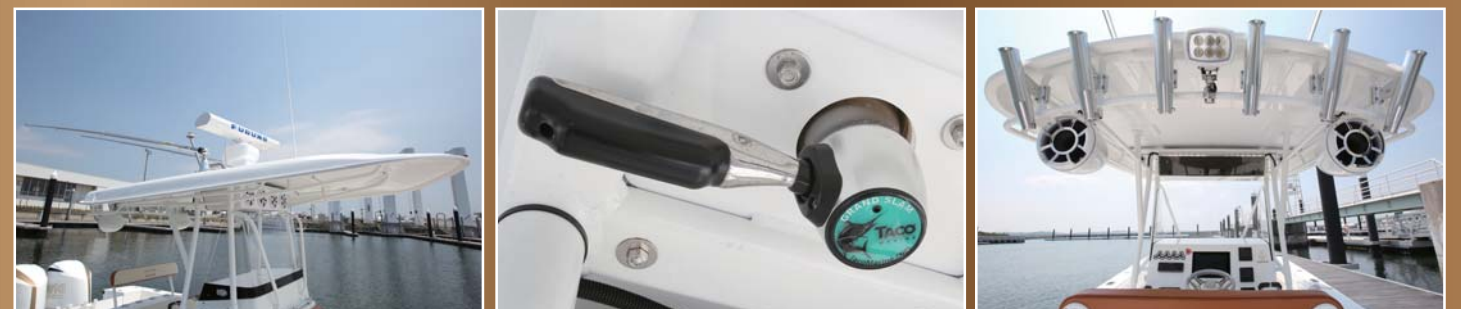
トップにはアウトリガーも装着されており、コンソールから簡単にセットできるため、トローリングにも対応可能だ。他にもロッドホルダーやスピーカーを装備。
