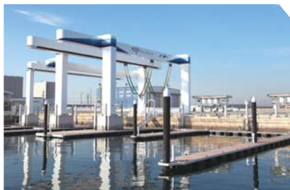
60t大型クレーン
