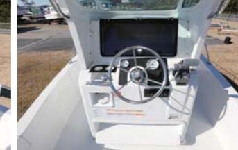
ウィンドウも大きく、ワイドな視野が広がる。航海計器BOXは8インチが2台収納可能。シートとの距離感も最適な幅を確保。計器類のレイアウトも機能的な配置。
