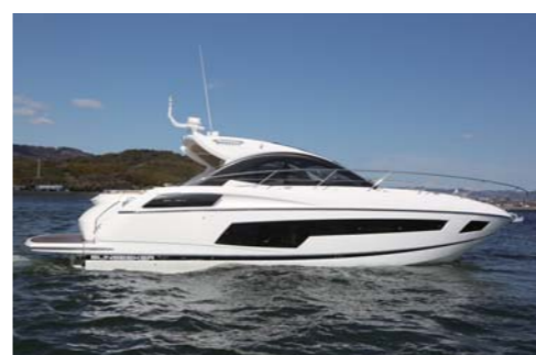
SUNSEEKER San Remo 50 全長:16.17m 全幅:4.3m 喫水:1.3m 重量 16,566kg 最高出力 435HP×2基 燃料タンク 1,320L 清水タンク 322L エンジン:Volvo Penta IPS600×2基
