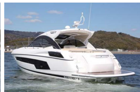
SUNSEEKER San Remo 50 全長:16.17m 全幅:4.3m 喫水:1.3m 重量 16,566kg 最高出力 435HP×2基 燃料タンク 1,320L 清水タンク 322L エンジン:Volvo Penta IPS600×2基
