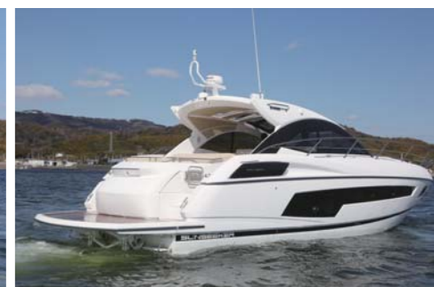
SUNSEEKER San Remo 50 全長:16.17m 全幅:4.3m 喫水:1.3m 重量 16,566kg 最高出力 435HP×2基 燃料タンク 1,320L 清水タンク 322L エンジン:Volvo Penta IPS600×2基
