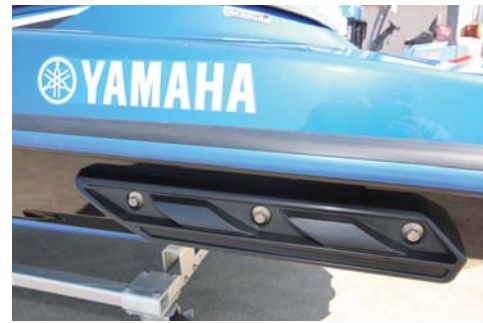
スポンソンも装備しており、マシンの操作性や安定感が増している。プラットフォームも広く、マリッジットにも活用できそうだ。後方にはステップも付いている。
