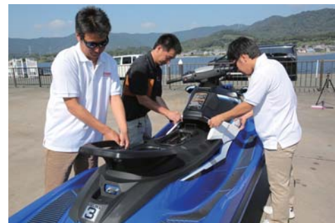
シートを外せばエンジンルームを確認できる。シートベースのボルト6本を外せば、エンジンのメンテナンスがスムーズだ。ボルトを外す手間は殆ど感じ無いだろう。
