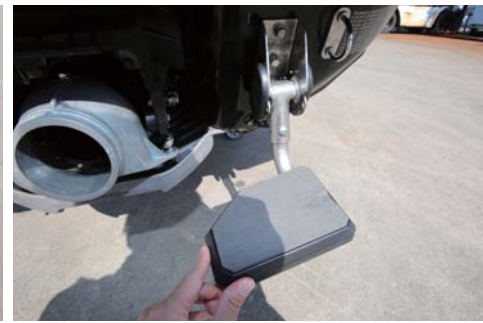
スポンソンも装備しており、マシンの操作性や安定感が増している。プラットフォームも広く、マリッジットにも活用できそうだ。後方にはステップも付いている。
