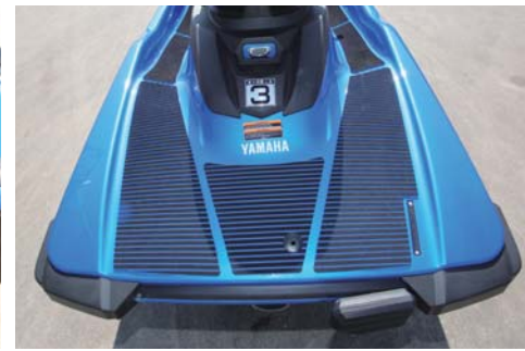
スポンソンも装備しており、マシンの操作性や安定感が増している。プラットフォームも広く、マリッジットにも活用できそうだ。後方にはステップも付いている。
