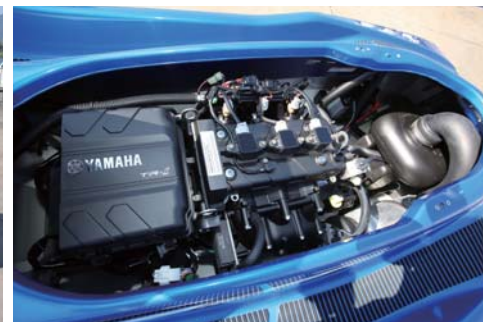
シートを外せばエンジンルームを確認できる。シートベースのボルト6本を外せば、エンジンのメンテナンスがスムーズだ。ボルトを外す手間は殆ど感じ無いだろう。
