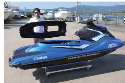
シートを外せばエンジンルームを確認できる。シートベースのボルト6本を外せば、エンジンのメンテナンスがスムーズだ。ボルトを外す手間は殆ど感じ無いだろう。
