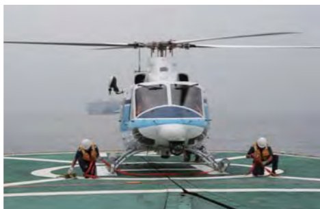
巡視船みずほのヘリポートに降りるヘリコプター。遠方での洋上救急の場合、海上の巡視船を経由する事で燃料補給もでき、より広範囲での活動が可能となる。
