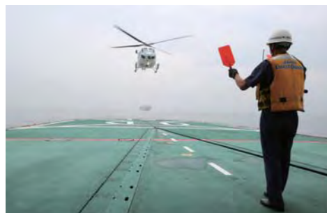
巡視船みずほのヘリポートに降りるヘリコプター。遠方での洋上救急の場合、海上の巡視船を経由する事で燃料補給もでき、より広範囲での活動が可能となる。
