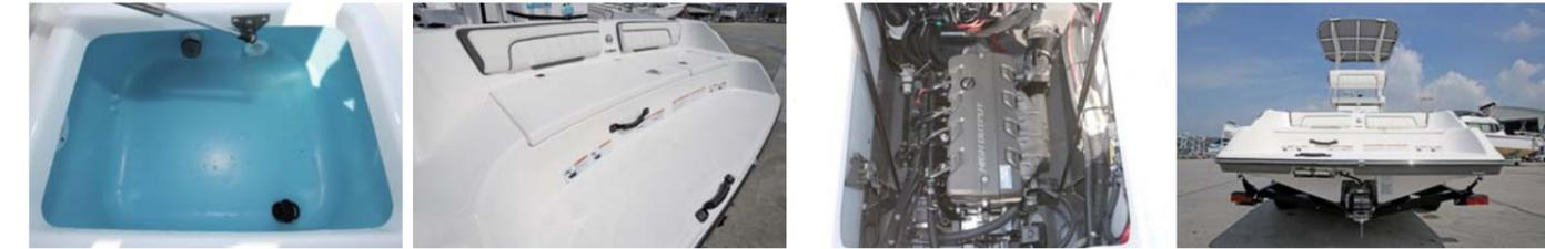
循環式のイセスも装備。スイムプラットフォームも面積が広い。エンジンは1.8L HIGH OUTPUT ENGINEを採用。ジェット推進のため船艇の下にペラは無い。
