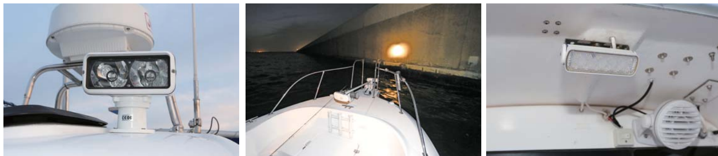
サーチライトがあれば前方の障害物の認識と距離感を正確に把握できる。また、デッキライトで船上を照らす事でデッキ内での移動や仕掛け作りもスムーズだ。
