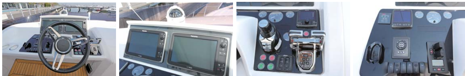
フライブリッジのヘルムステーション。全体に広げ過ぎずコンパクトにまとめつつも、見やすいサイズのレイマリンを2基装備しており、快適な操船が楽しめそうだ。
