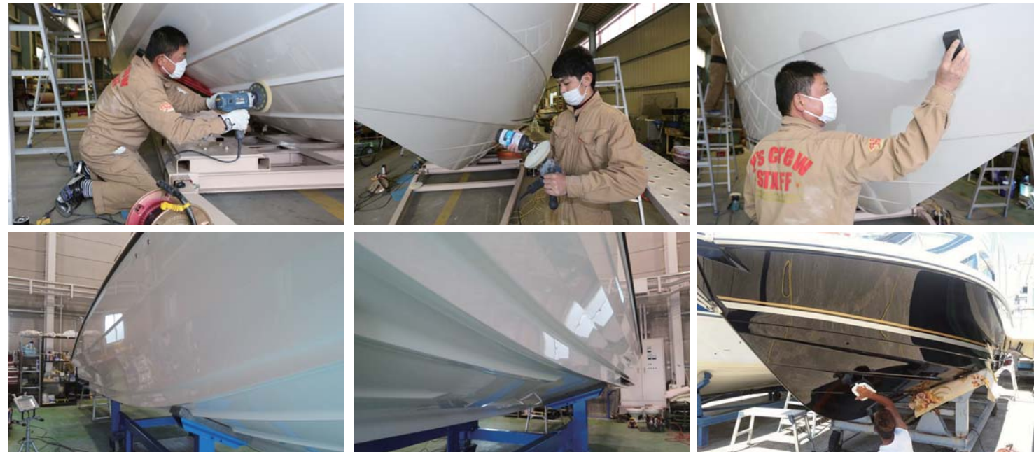
ポリッシャーの馬力、研磨剤の種類、先端に付けるスポンジパフやウールパフを施工するボートの状態に合わせて巧みに組み合わせる。この組み合わせが非常に重要で、この部分は長年の実績から積み上げた経験で判断している。過去に磨かれたボートのハルを見て欲しい。光沢感が素晴らしく、見た目とても映える。
