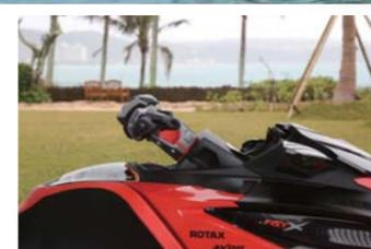
ハンドルの高さも調整可能で、長時間の操船の疲労も軽減してくれそうだ。
