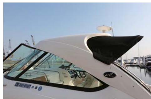
ヘルムステーションは実用性も高く、操船の際にも煩わしさは無い。エンクロズドハードトップを採用しており、急な天候の変化にも十分対応が可能だ。
