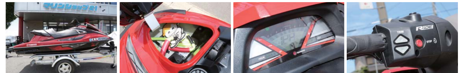
MJ-VXRはコックピットのデザインを一新しており、デジタルメーターも多機能で非常に見易い。注目のRiDEはハンドル左にあり、左側ではトリムの調整も可能。
