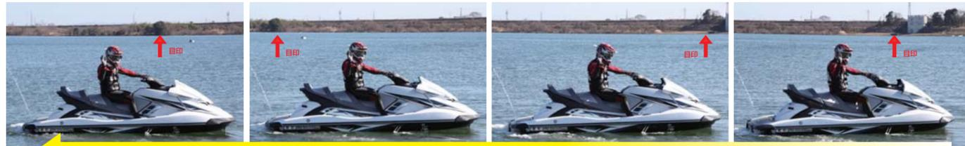
ニューモデルの目玉機能はやはり革新的な新技術となるRiDEだ。ハンドル左側に設置されているレバーを指で操作するだけで静止時には後進も可能である。
