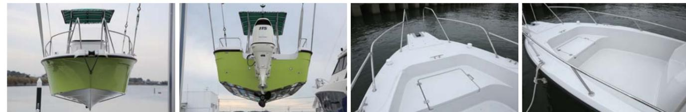
ハルはV型船型で安定感は抜群。ツートンカラーの場合は写真の様に船底が白になる。パウにはパウレールや十分な横幅が確保されており、釣りもし易そうだ。
