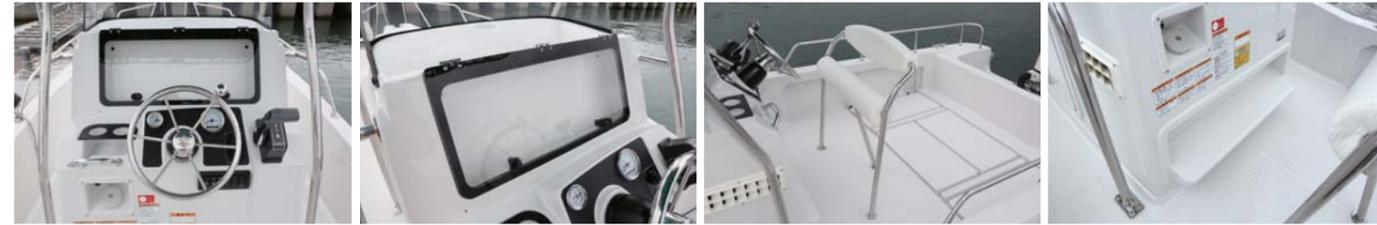
センターコンソールのパネルレイアウト。航海計器BOXは8インチが2台収納可能。リーニングシート(OP)の高さも調度良く、足下にはフットレスト(OP)もある。
