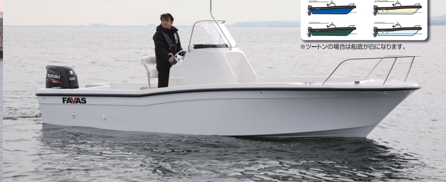
していこうと思う。センターコンソールには見易い位置に航海計器類が取り付け可能となっており、スロットルレバーも操作しやすい位置に取り付けられていた。パウデッキにはパウレールが取り付けられており、ジギングもし易そうだ。また、船首キール部にフィンキールを採用した事で風流れも軽減出来そうだ。他にもコンソール前方には大人
