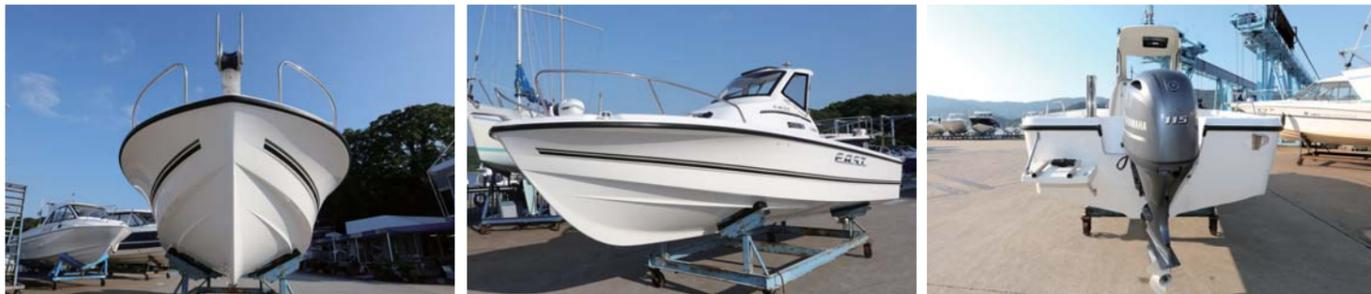
大型フレアーは両サイドに大きく張り出しブレーをカット。ウェーブスラスタブレードは風流れを抑止する。後部のフラットキールは浜座りも可能にする。
