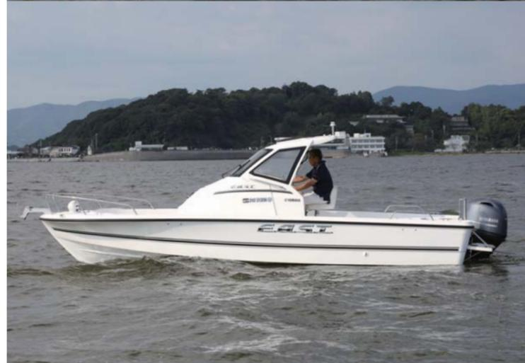
ボートが角度のキツイコーナーリングに差し掛かった時である。F.A.S.T.23は低重心のフォルムから安定した姿勢を保ちつつ、僅かに船体を内側に傾けながらキュッと音が聞こえてきそうな鋭いコーナーリングを見せたのである。まるで横に平行移動するかのような安定したコーナーリングを見ていると、このボートの特徴でもある船型がパッと頭をよぎった。両端に大きく張り出して凌波性を向上させるとともに、スプレーをしっかりとカットする大型フレアー、高い乗り心地と風流れ抑制性能を誇るウェーブ・スラスタ・ブレード、そして、船尾まで伸びたフラットキールは優れた保針性を発揮し、更には浜座りさえ可能にする。この3つのポイントは乗り心地を大きく左右する重要な要素であると言っても過言では無いのだ。コーナーリングを繰り返していると引き波を越えていくシーンもあるのだが、しっかりと波を切り、スプレーもカットしていた。走行性能をチェックした後は陸上に揚げてデッキスペー
