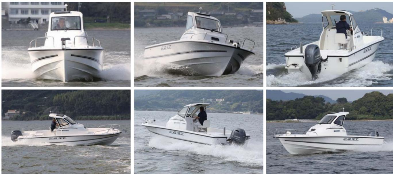
F.A.S.T.23は俊敏な走りを楽しめる23フィートのフィッシングボートだ。船外機はヤマハF115とF90が選択可能で、取材艇にはF115が搭載されている。スロットルを倒してからスピードに乗るまでの時間も早い。船首部分の大型フレアーはスプレーをしっかりとカットしており、波を被る様子はほとんど無かった。
