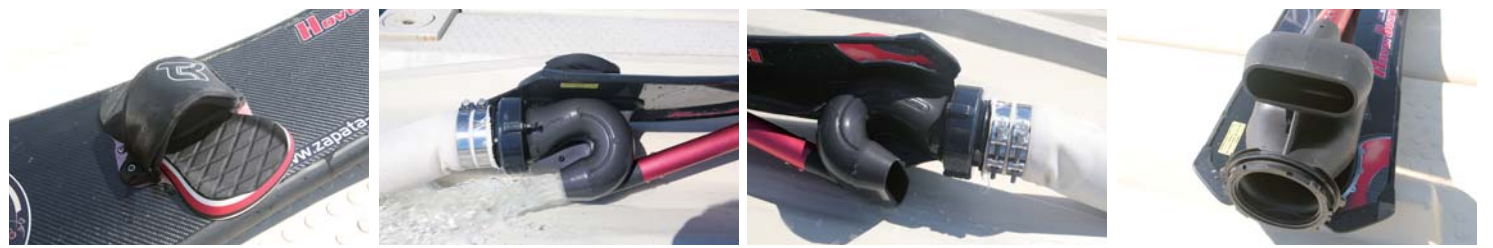
ホバーボードの推進形式はフライボードと同様にPWCから供給されるパワフルな水流だ。ホースをPWCとボード本体に固定し、アクセル操作はPWC側が行う。
