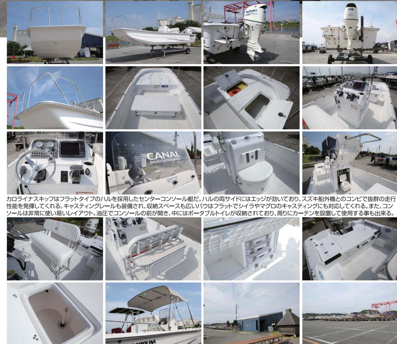
カロライナスキッフはフラットタイプのハルを採用したセンターコンソール艇だ。ハルの両サイドにはエッジが効いており、スズキ船外機とのコンビで抜群の走行性能を発揮してくれる。キャストングレールも装備され、収納スペースも広い。ハルはフラットでシイラやマグロのキャストングにも対応してくれる。また、コンソールは非常に使い易いレイアウト。油圧でコンソールの前が開き、中にはポータブルトイレが収納されており、周りにカーテンを設置して使用する事も出来る。
