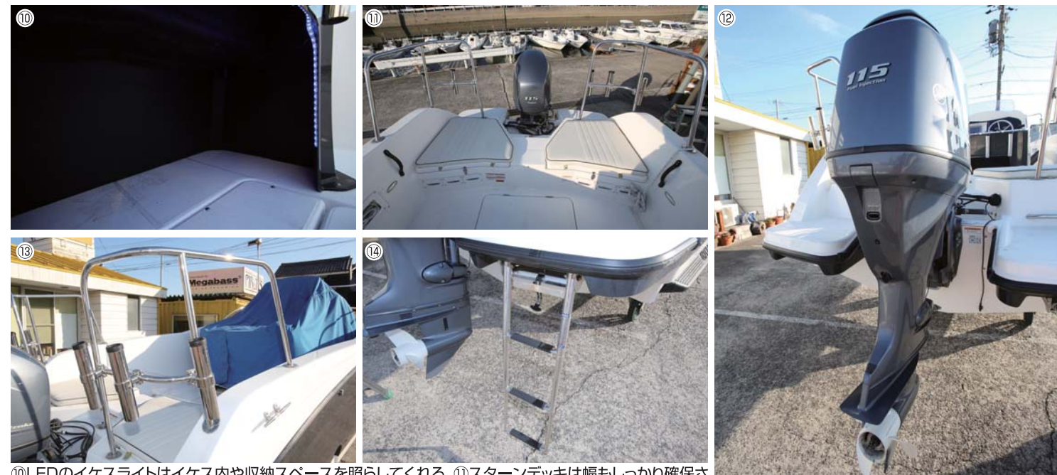
⑩LEDのイクスライトはイクス内や収納スペースを照らしてくれる。⑪スターンデッキは幅もしっかり確保され、リアシートクッションを両サイドに設置。⑫エンジンは高馬力のヤマハF115AETXを使用している。⑬スターンレールにもロッドホルダーを装着。⑭トランサムラダーもあり、水中からのアクセスも便利。
