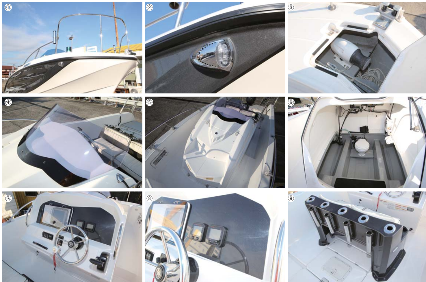
①釣りに最適な高さを確保したパウレール。②スタイリッシュなデザインのライト。③パウロッカーにはウインドラスが内蔵されている。④ウインドシールドによって、風の負担を軽減出来る。⑤カディエントランスハッチ内は広く、大型のラゲージルームとなっている。⑥電動マリントイレも設置され、長時間の釣りに最適。⑦コックピットは気分の高まる効率的なレイアウト。⑧ダッシュボードには各種メーター類が機能的に配置されている。⑨このロッドホルダーだけで9本のロッドが収まる。
