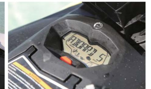
液晶メーターはグローブボックスの前に配置されており、スポーツ/ツーリングのモードも切り替える。
