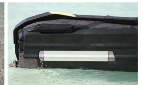
エンジンマウントを兼ねたハル左右のプレートでは、熱交換が行われる。
