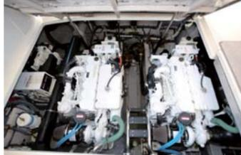
cockpit のシート下には407hpのエンジンが2基搭載されている。
