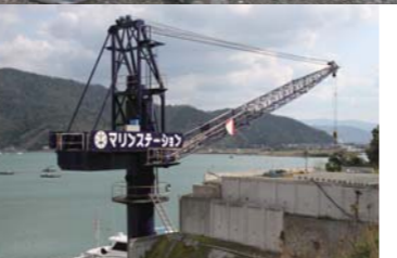
大型クレーン(15t)も完備している。
