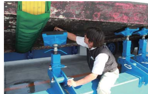
まずは、内部にあるフレームの位置を確認し、そこに手動ジャッキが当たるように調整していく。
