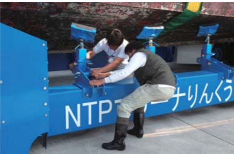
手動ジャッキは横にスライド移動が可能な構造となっているので、フレームの位置までスライドさせる。
