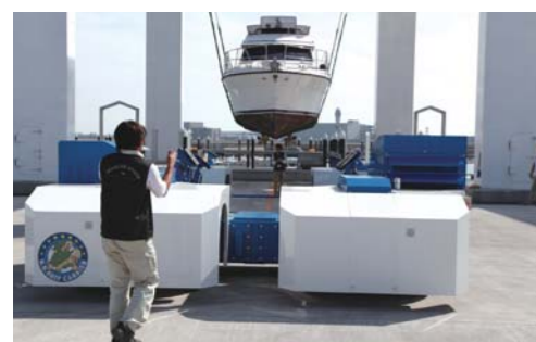
シップキャリアの位置を微調整して、ホイストからボートを降ろす際に中心で受けれるようにする。
