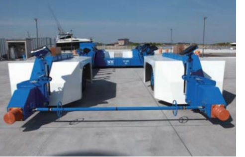
タイヤカバーを設置し、足の巻き込みを防ぐ。また、オレンジの部分はクッションとなり、衝撃を和らげる。
