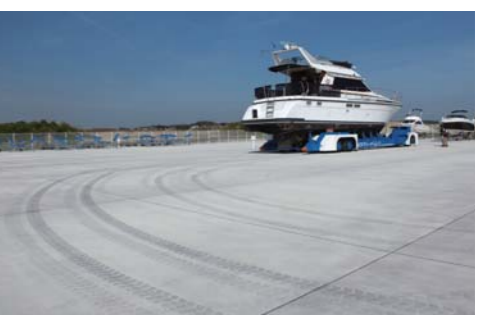
ステアリングは前後2箇所ずつ、計4箇所にて前・後独立した制御が可能で、驚く程に小回りが効く。
