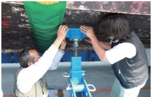
高さもハンドルを回すことで調整可能。ハルの位置まで高さを上げて、しっかりとボートを固定する。
