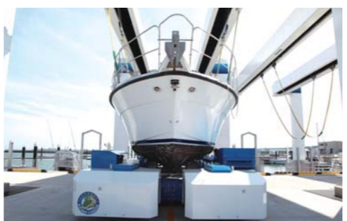
中心に降ろす時、手動ジャッキの手前で一時停止。ここからの微調整は手動ジャッキで行うことになる。
