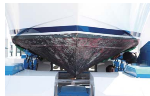
手動ジャッキをしっかりと固定したら、搬送準備完了。キール部分は中に浮いた状態となっても安心。
