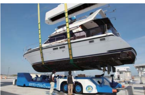
ホイストから徐々にボートを降ろしていく。この際は、両サイドの着地位置の目安を正確に把握していく。
