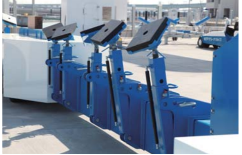
手動ジャッキは各ボートの船底に合わせて、細かく微調整出来るため、しっかりとボートに固定出来る。
