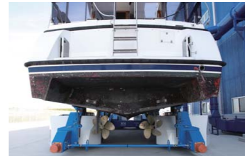
横幅は十分に確保してあるため、大型艇を乗せても、安定感がある。また、ペラとの接触も全くない。
