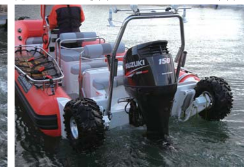
船外機を徐々にチルトダウンし、浮いた時にスタート。
