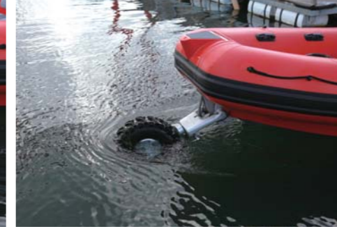
油圧で持ち上げるとタイヤが水面に出て来る。
