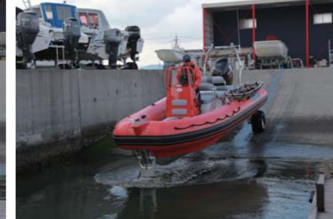
タイヤ走行時は油圧モーターの3輪駆動で動く。
