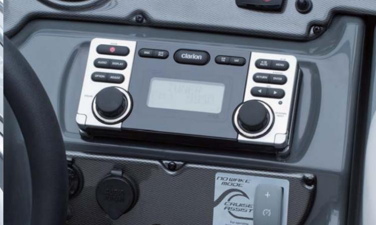
CDプレーヤーに加え、MP3用の入力端子を装備。また、クルーズアシスト、ノーウェイクモードのスイッチも扱い易い位置にレイアウトされている。
