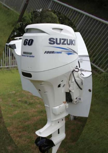
取材艇のエンジンはDF60を使用。量産船外機に世界で初めて、EPI(電子制御燃料噴射装置)を採用した4ストローク船外機。
