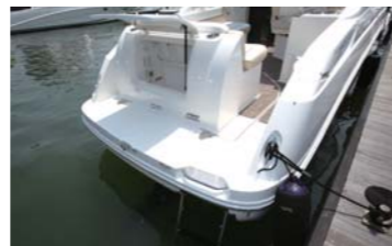
スターン部分の収納とラダーステップ。
