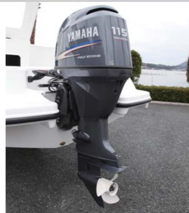
高い信頼性、耐久性、優れた動力性能を実現しているヤマハの4ストローク船外機。取材した船はF115AETXを装備。
