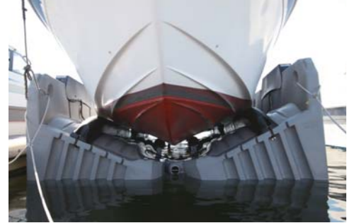
タンク内の空気圧の変位によって昇降しています。
