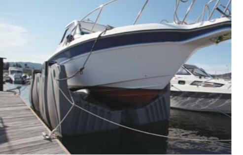
リフトを陸上にロープで固定して使用します。
