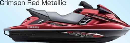
全 長: 3.56 m 乾燥質量: 386 kg 搭載馬力: 154.5kW[210ps]
