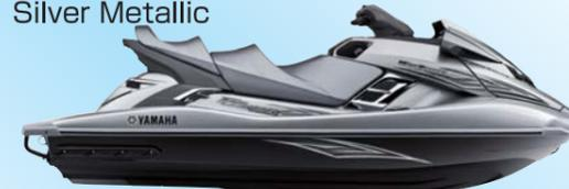
全 長: 3.56 m 乾燥質量: 374 kg 搭載馬力: 132.4kW[180ps]
