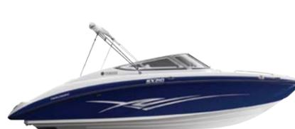
全長(m):6.5、全幅(m):2.6、完成質量(kg):1304、定員(名):9、搭載エンジン:1052cc Engine×2、燃料タンク容量(L):190(※リザーブタンク含む)、最大馬力(PS):102×2、エンジンタイプ:4ストローク/4気筒
