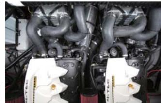
4ストローク3気筒、インタークールドスーパーチャージャーエンジン2基搭載。
