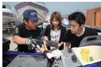
エンジンオイルの量を確認します。これが足りないと大変です。
