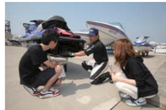
船体のチェック。全体を細かく確認します。船底、ポンプケース、ポンプノズル等の異常がないかのチェックです。
