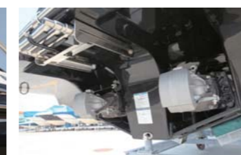
ジェット推進を生み出すジェットノズル。リバースも可能。
