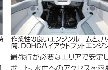
作業性の良いエンジンルームと、ハイパワーの1,812cm 3 、4ストローク4気筒、DOHCハイアウトプットエンジン。
