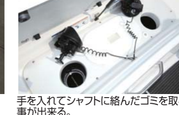
手を入れてシャフトに絡んだゴミを取る事が出来る。
