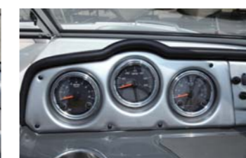
三連アナログメーター中央がスピード、左右がタコメーター。
